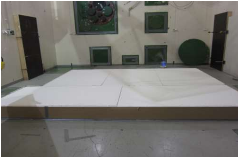
Kuva 1. Näyte asennettuna mittauspaikalle.
